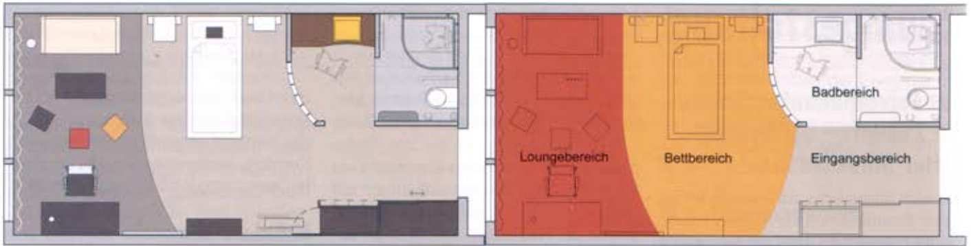
Die Raumaufteilung des im März in Berlin vorgestellten Privatpatientenzimmers wird geprägt durch den Eingangsbereich, durch das Bad sowie durch den Bett- und Loungebereich.
