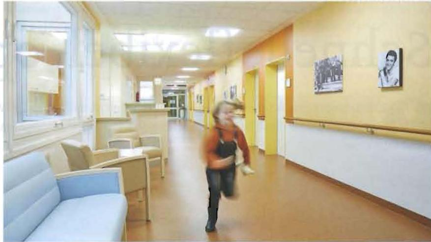
*Zur besseren Orientierung sind im Flur die Türzargen und Handläufe kontrastreich abgesetzt. Dadurch sollen sich auch an Demenz Erkrankte und Personen mit eingeschränkter Sehfähigkeit gut zurechtfinden können.*
